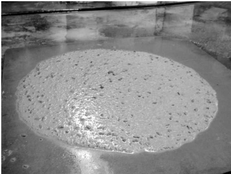
شکل الف ۳- بتن با حلقه محیطی و درخشندگی آب در سطح آن (VSI=2)
