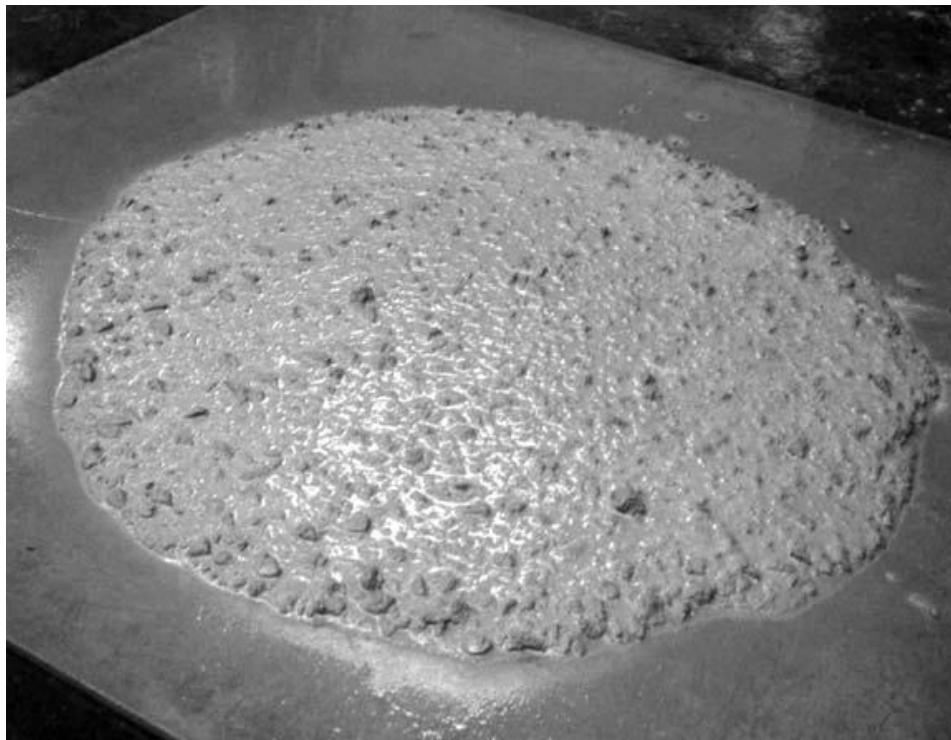
شکل الف ۲- بتن با کمی آب انداختگی و درخشندگی سطح (VSI=1)
